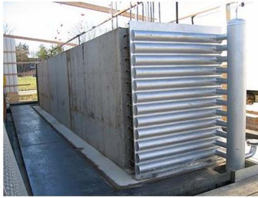
Figure 2 : Module de stockage utilisant le béton [14].
