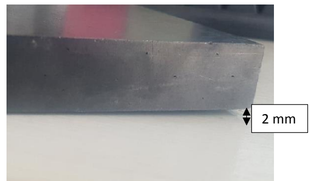
Figure 206 : Image du matériau composite déformé après 2 cycles
