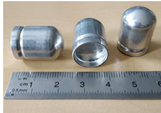
Figure 213 : Capsule en aluminium contenant le matériau composite
