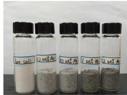
Figure 19 : Image des échantillons représentant du MCP pur et du matériau composite à différentes fraction massique [64].
