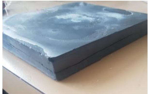
Figure 208 : Fissures du matériau composite après le vieillissement
