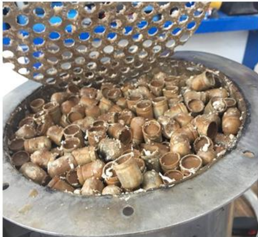
Figure 216 : Images de l'échangeur-stockeur après les 8000 cycles
