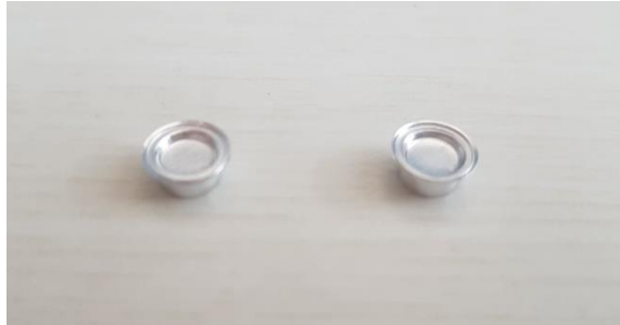
Figure 86 : Image des capsules utilisées en DSC
