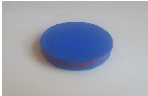
Figure 141 : Photo du matériau composite ou MCP encapsulé en élastomère.
