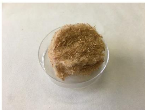
Figure 2-3. Exemple : éprouvette de l'isolant A (fibres de bois)
