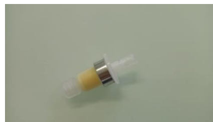
Figure 2-8. Cartouche DNPH destinée au prélèvement des COV carbonylés
