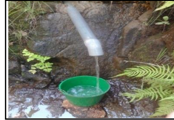
Photo 14: Mesure de débit de la source 2
