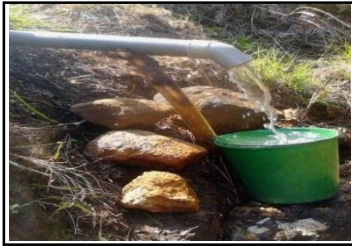
Photo 13: Mesure de débit de la source 1
