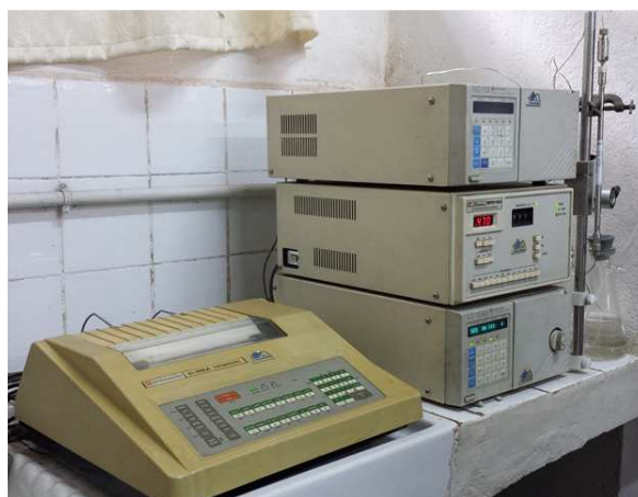
Figure 11 : Photo de l'appareil CLHP du LIA (cliché de l'auteur)
