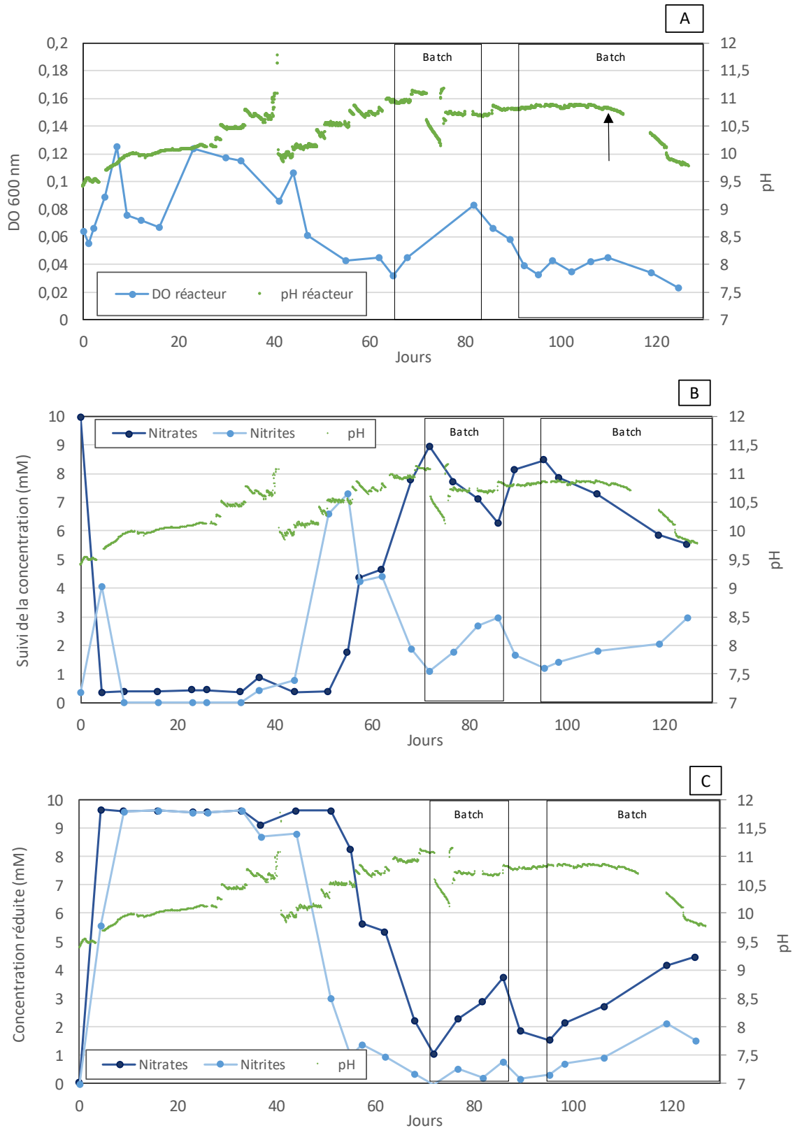
Figure 50 : Influence de l'élévation du pH de 8,5 à 11,2 en réacteur continu sur les évolutions du pH et de la DO (A), des concentrations en nitrates et nitrites (B), des concentrations en nitrates et nitrites réduites (C). Conditions expérimentales : un bioréacteur continu, lixiviat de ciment, bactéries issues de boues activées, 20 mM d'acétate, 10 mM de nitrates.
