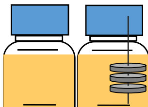
Figure 91 : Protocole de l'expérience d'insertion de pâtes de ciment frais dans des cultures de boues activées hydrogénotrophes.
