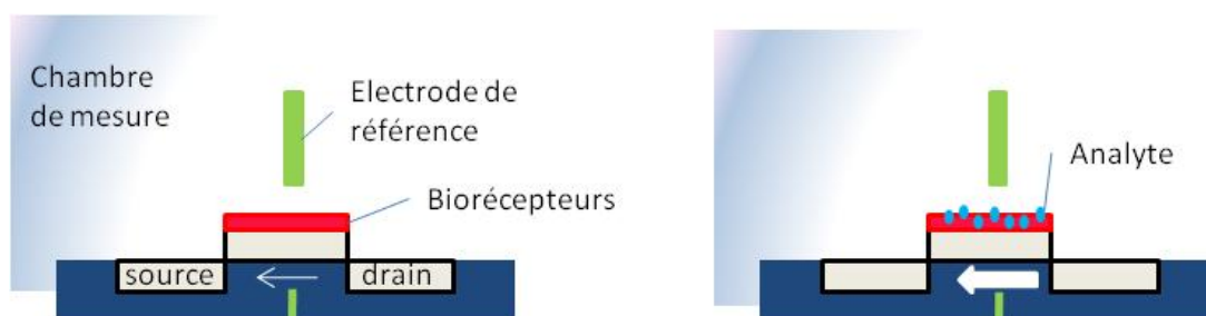
Figure 1.21 : Principe de fonctionnement d'un ISFET par transduction potentiométrique. Ici le transistor sert à mesurer le potentiel de la grille biosensible.
