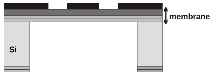
Figure II.10. Topologie de la ligne CPW sur membrane
