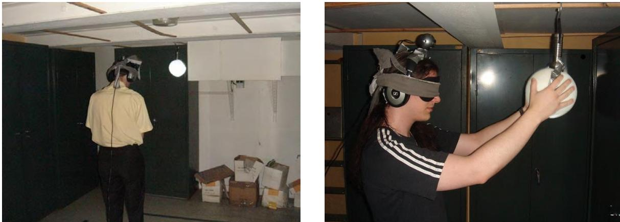
Figure I-19 Tâche de localisation et de préhension d'une cible à l'aide du dispositif The Vibe.
