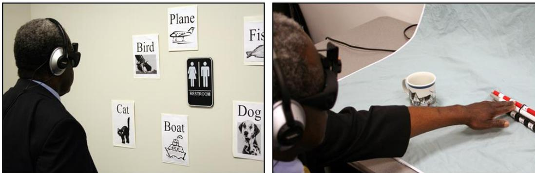
Figure I-46 Expérimentation du dispositif proposé dans [Cheng et al., 2008] permettant de localiser des objets grâce à une interface sonore et aux descripteurs SIFT.
