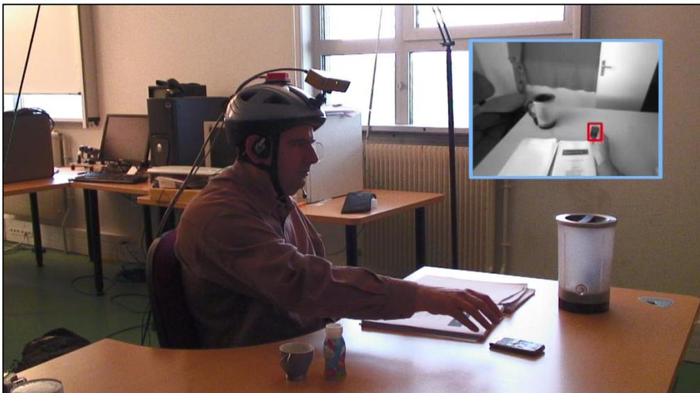
Figure II-20 Localisation et préhension d'objet. Le téléphone recherché est reconnu par le module de vision, et un son 3D est synthétisé à la position calculée par stéréovision.
