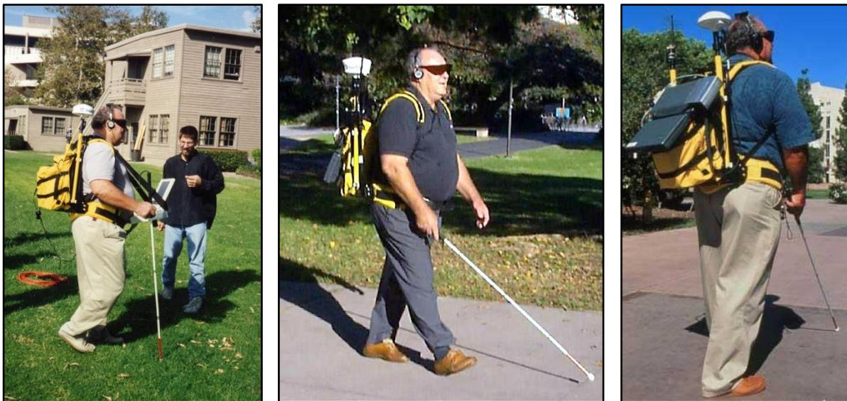
Figure I-38 Personal Guidance System (PGS) développé par Loomis et son équipe de l'Université de Californie (photographies du prototype original mis au point en 1993).
