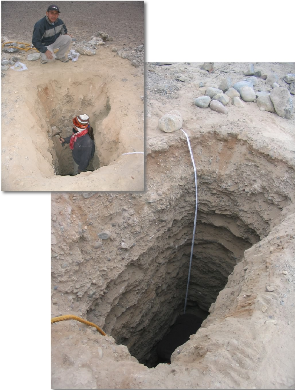
Figure 33 : Photographies d'un échantillonnage d'une terrasse marine de dépôts le long d'un profil en profondeur (Chala, Pérou). Pour réaliser cet échantillonnage, nous avons creusé des fosses d'environ 2 m de profondeur dans la terrasse et échantillonné des galets prélevés à différentes profondeurs.
