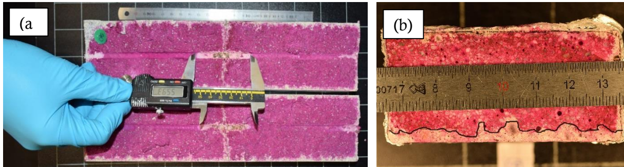
Figure 58 : (a) Longueur carbonatée à l'interface acier/mortier sur un échantillon fissuré ; (b) épaisseur carbonatée sur un échantillon non fissuré
