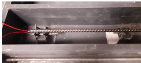
Figure 38 : Préparation des moules pour la confection des échantillons destinés à l'étude de corrosion par suivi de courant
