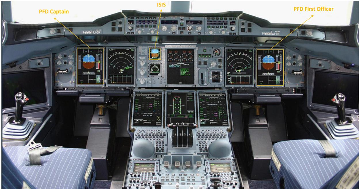
Figure V.2 Redondance d'affichage dans le cockpit (A380)
