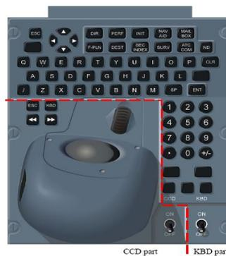
Figure III.1 Exemple d'un KCCU
