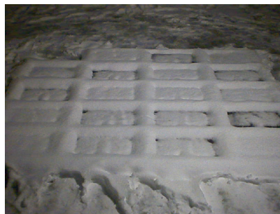
Figure 4.18 : Processus de fonte naturelle sur les revêtements du site du LRPC de Nancy
