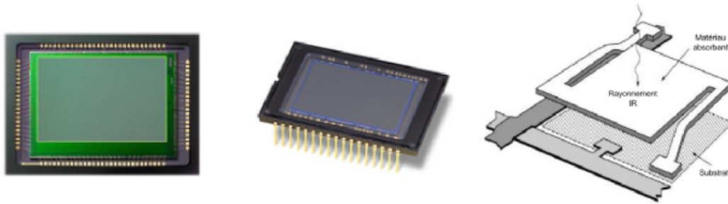
FIGURE 2.4 – Présentation des capteurs communément utilisés. À gauche un capteur CCD. Au centre, un capteur CMOS et à droite, un microbolomètre
