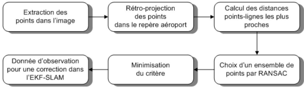
FIGURE 5.2 – Algorithme proposé pour l'appariement points-lignes et l'intégration du résultat dans le SLAM EKF.
