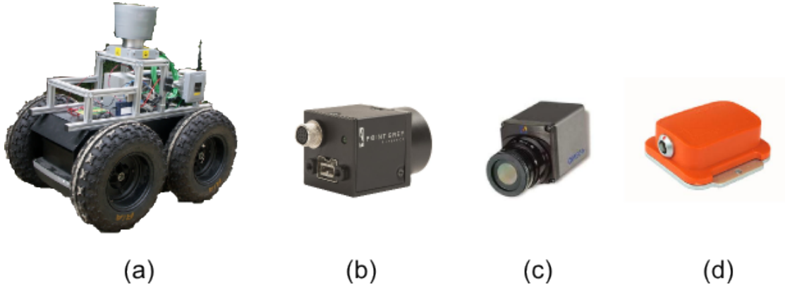
FIGURE 4.10 – Equipements expérimentaux utilisés au LAAS pour l’acquisition des données. (a) Robot d’exploration Mana . (b) Caméra Flea2 IEEE1394 monochrome développée par PointGrey , avec une résolution de 640 \times 480 . (c) Caméra A10 IEEE1394 infrarouge bande III développée par Flir , avec une résolution de 160 \times 120 . (d) Centrale Inertielle produite par Xsens .
