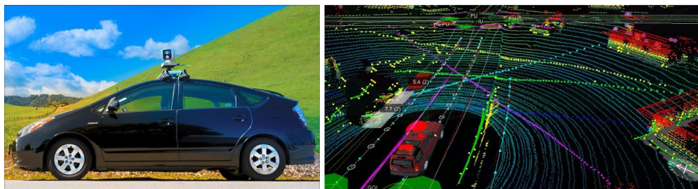
FIGURE 4.13 – Le Velodyne, monté ici sur le toit de la Google Car , est un excellent capteur qui fournit une carte 3D à 360° de son environnement. Mais son coût élevé et son encombrement limite sa diffusion sur des applications spécifiques (sécurité civile ou militaire ...).
