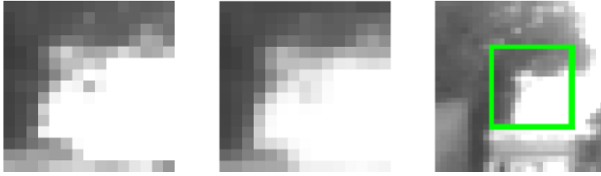
FIGURE 4.6 – Images intervenant lors de la corrélation. À gauche, le descripteur correspondant à l’amer lors de son initialisation. Au centre, la prédiction de ce descripteur au moment de la corrélation et après mouvement du système, et à droite, la position dans la zone d’incertitude où ce descripteur prédit a été trouvé en maximisant le score ZNCC.
