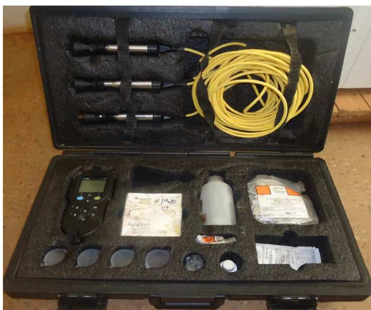
**Figure 10 :** *Kits du multimètre HACH HQ 40d*
