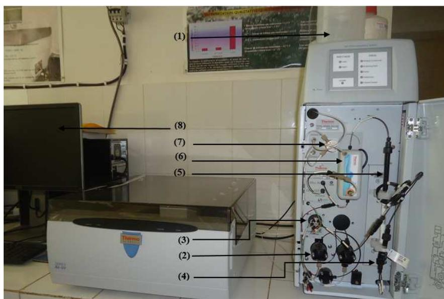
**Figure 12** : Système de chromatographie ionique DIONEX ICS 1100
