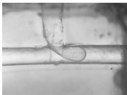
Figure 58 : Formation de goutte dans une jonction T
