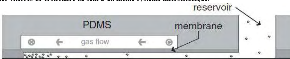
Figure 18 : Schéma de principe du microévaporateur, d'après Leng 27
