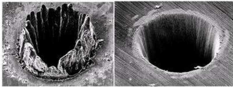
FIG. 1.3 – Comparaison entre un perçage effectué en mode nanoseconde (à gauche) et en mode femtoseconde (à droite).
