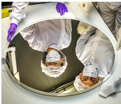
FIGURE 5.8 – Démonstrateur d'une membrane Ø800mm pour un miroir actif traité avec l'empilement MMLD mis au point au cours de cette étude.
