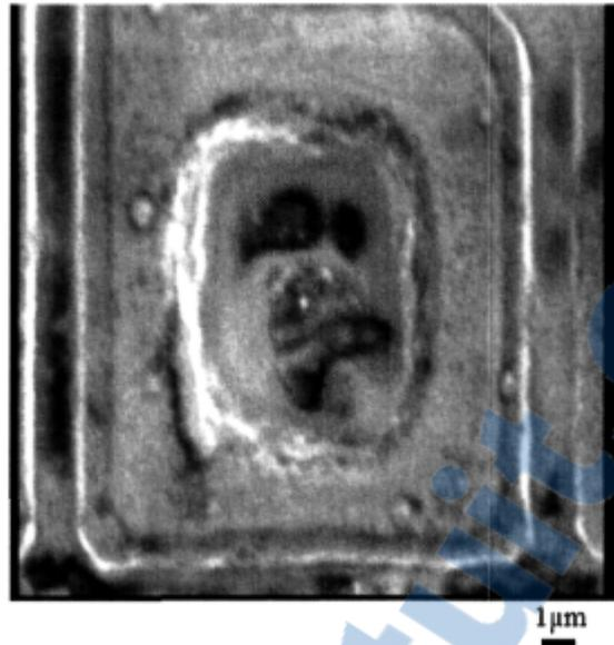
*Figure 33. Dégradation des pôles observée en microscopie électronique.*
