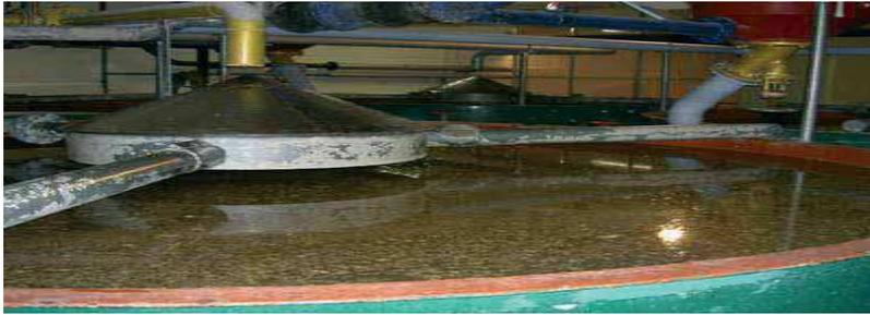
Figure 1: cuve cylindro-coniques de trempage
