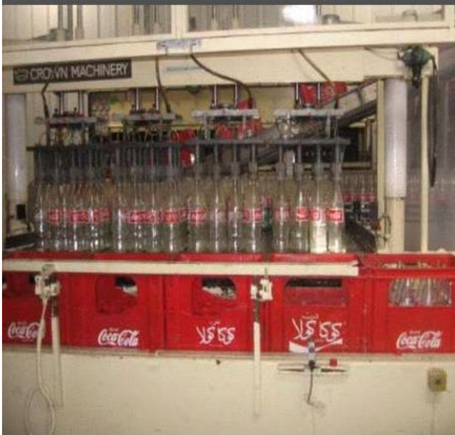
Figure 3 : dévissage des bouteilles
