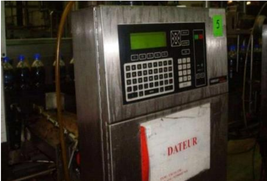
Figure 8 : le codage des bouteilles par un dateur
