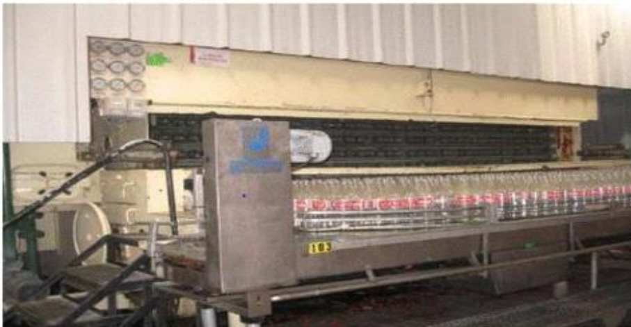
Figure 4 : la laveuse des bouteilles
