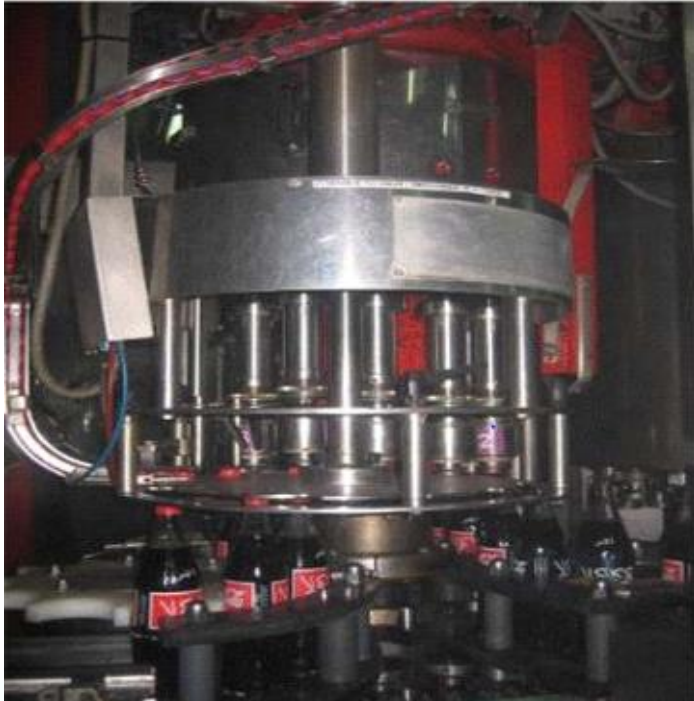
Figure 7 : le bouchage des bouteilles
