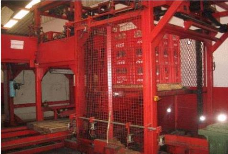
Figure 2 : Dépalettisation des lots des bouteilles.
