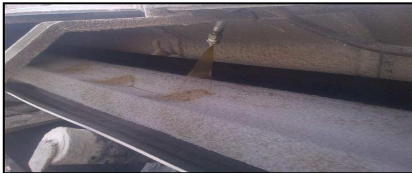
**Figure 14 : pulvérisation d'huile au niveau de la bande de déstockage**
