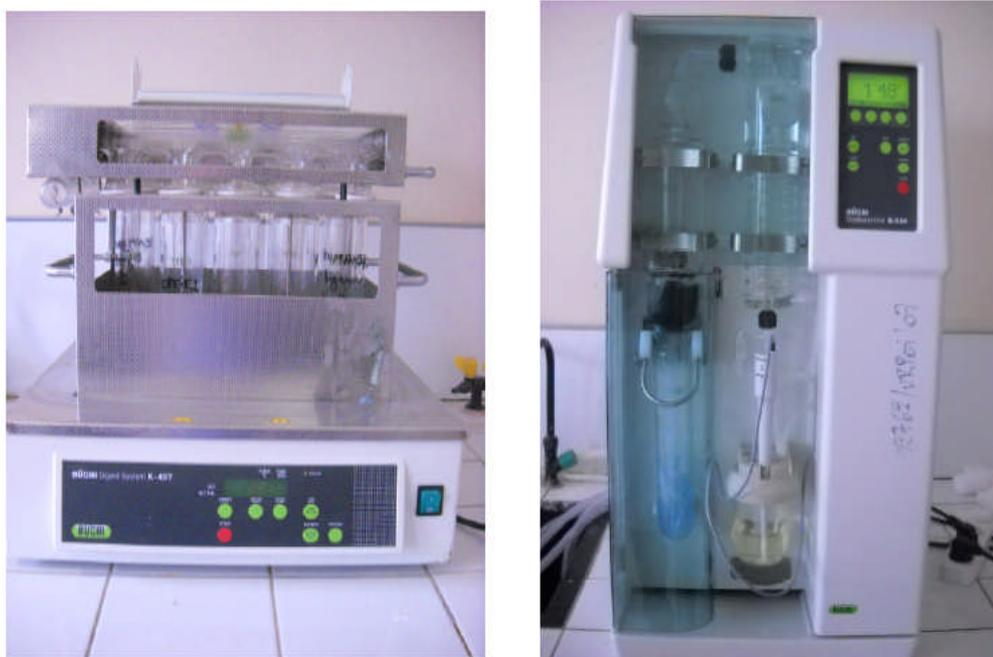
**Figure N° 3 :** Minéralisateur (à gauche) et distillateur (à droite) de Kjaldhal.
