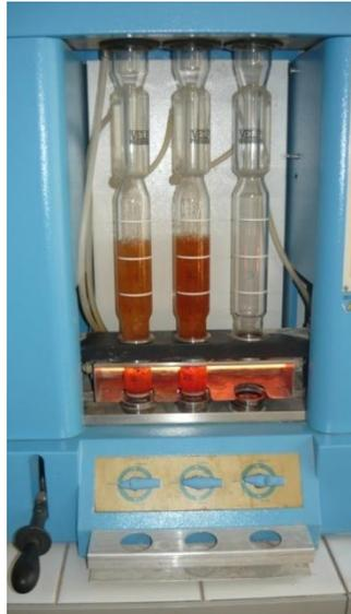
**Figure 9:** appareil extracteur de fibres
