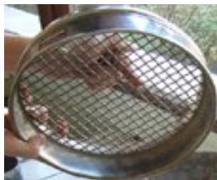
Figure n°12: Photo représentative d'un tamis utilisé pour l'analyse granulométrique
