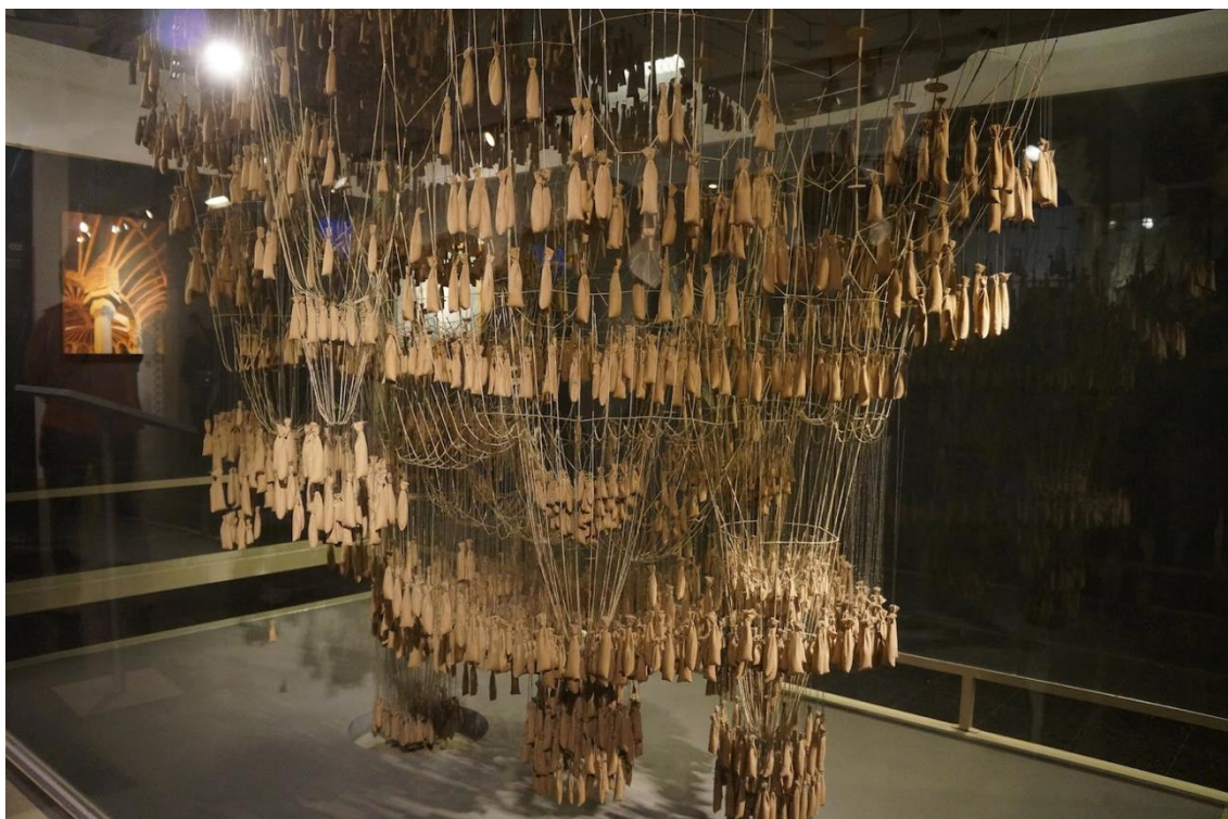
Figure 47 Reconstruction du modèle suspendu de Gaudi pour la Colonia Güell Chapel
