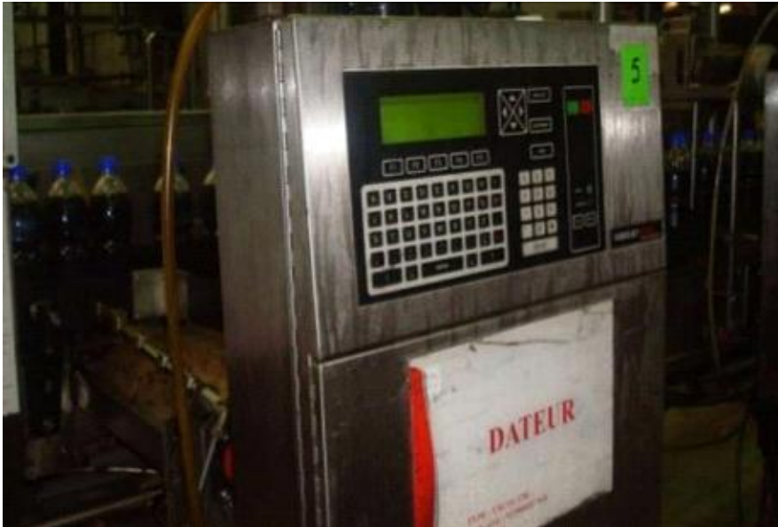
Figure 8 : le codage des bouteilles par un dateur
