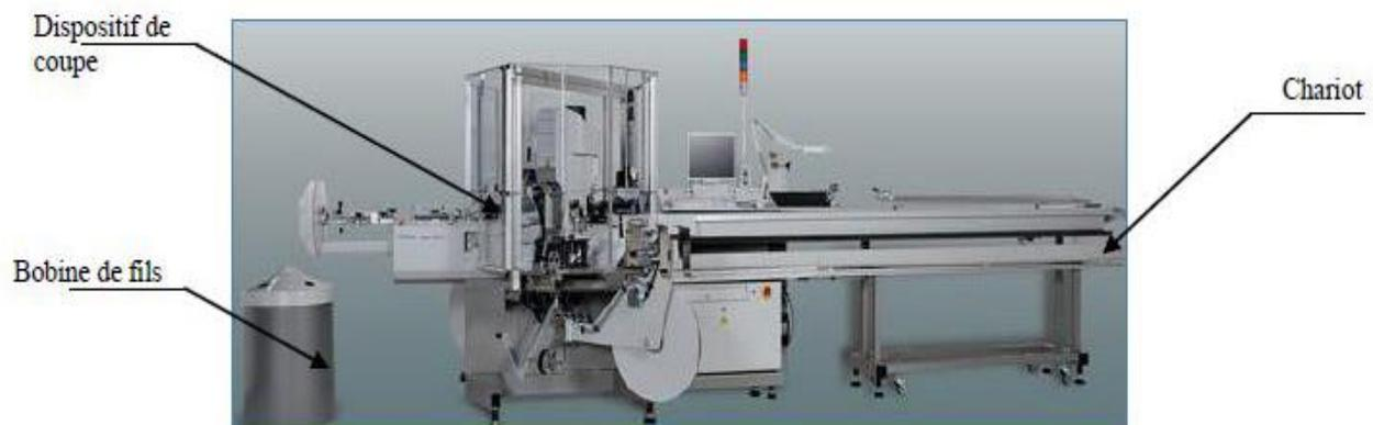
Figure 10 Machine de coupe
