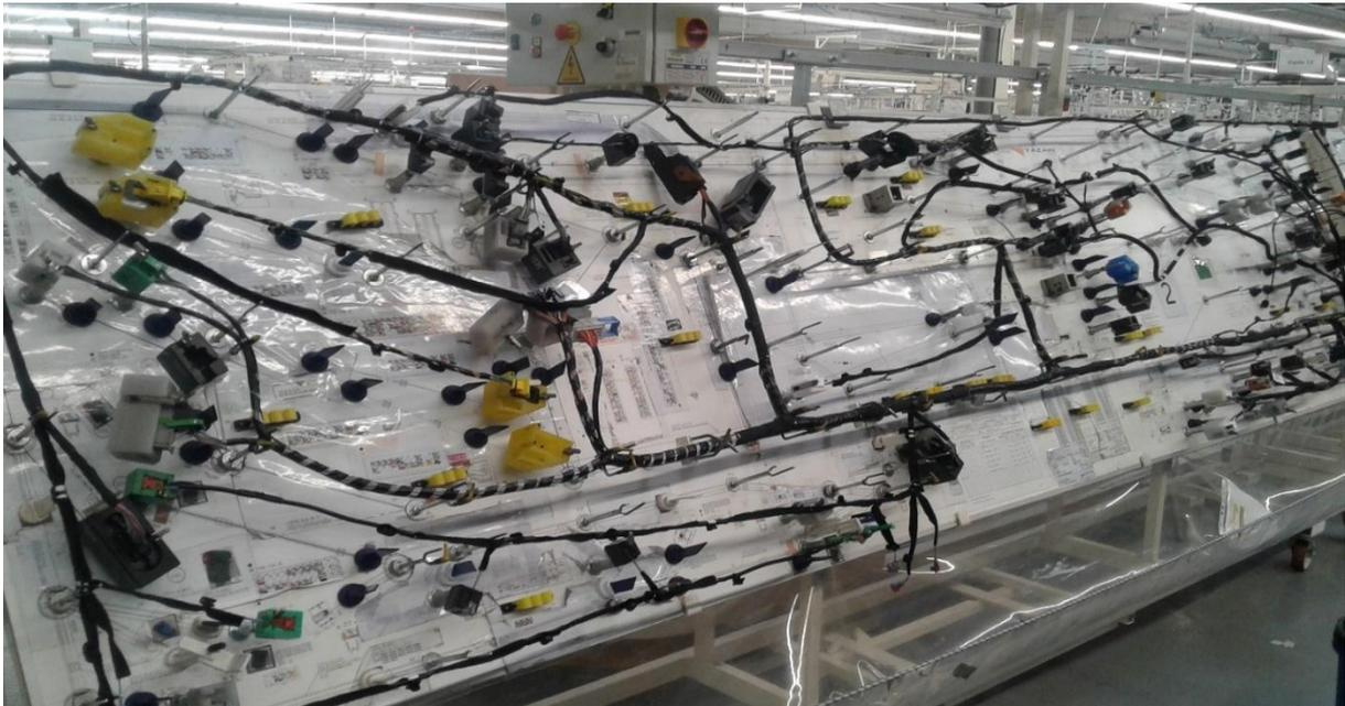
**Figure 15** Assemblage câble ‘enrubannage’
