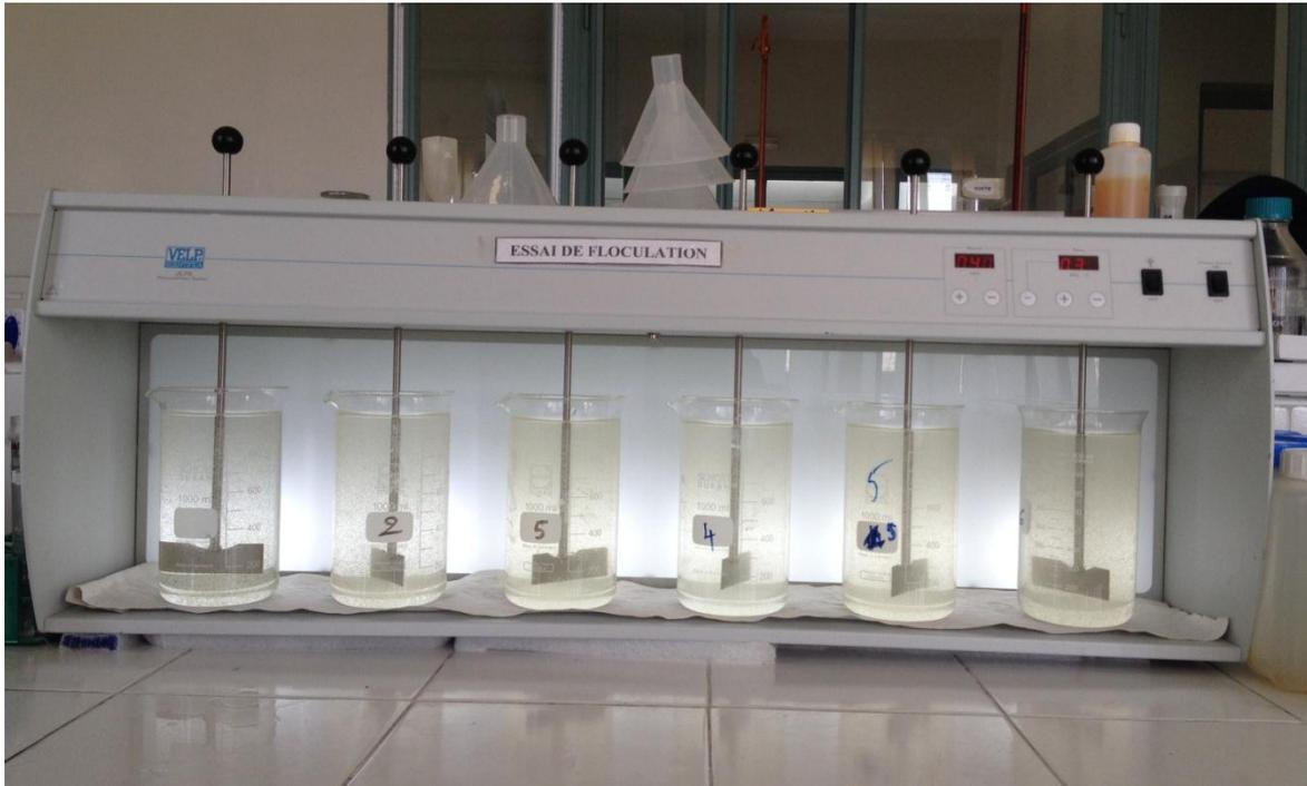
**Figure7: schéma de dispositif expérimental de l'essai de coagulation-floculation <<Jar Test>>**
