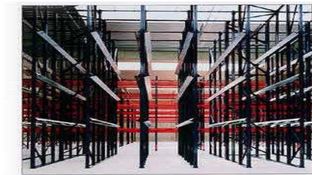
Figure 11: stockage par accumulation
