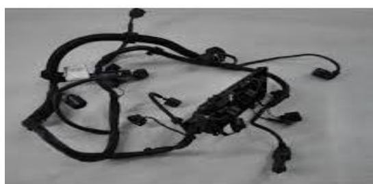
Figure 4: faisceau d'une porte d'automobile
