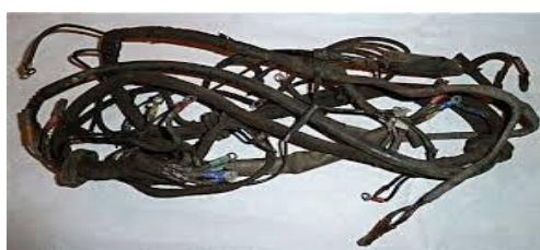
Figure 3: faisceau d'intérieur d'automobile
