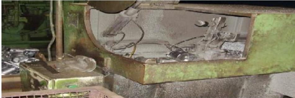
**Figure 9** : La machine de démasselottage
