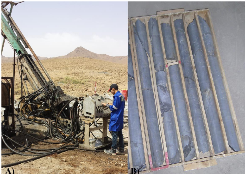
Figure 65 : A. Sondeuse carottière à couronne diamantée, B. roche sous forme des carottes découpés par la sondeuse
