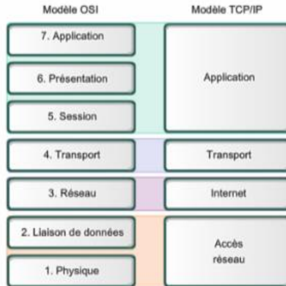
Figure 4: correspondance modèle OSI et modèle TCP/IP
