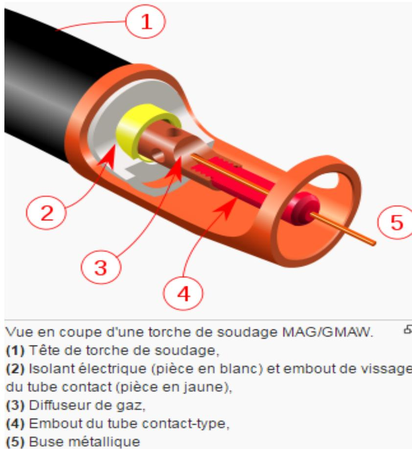
**Figure 2.2:** vue en coupe d'une torche de soudage MIG/MAG
