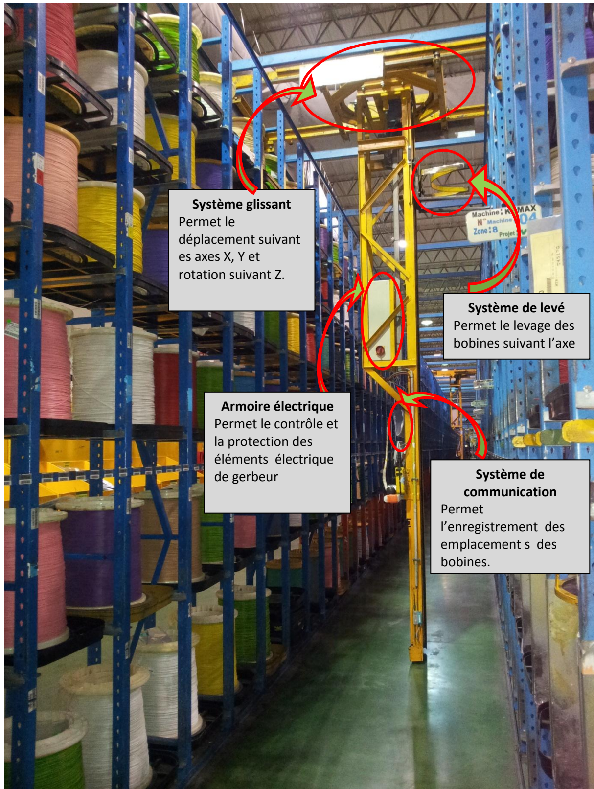
Fig11' : constituant d'un gerbeur manuel
