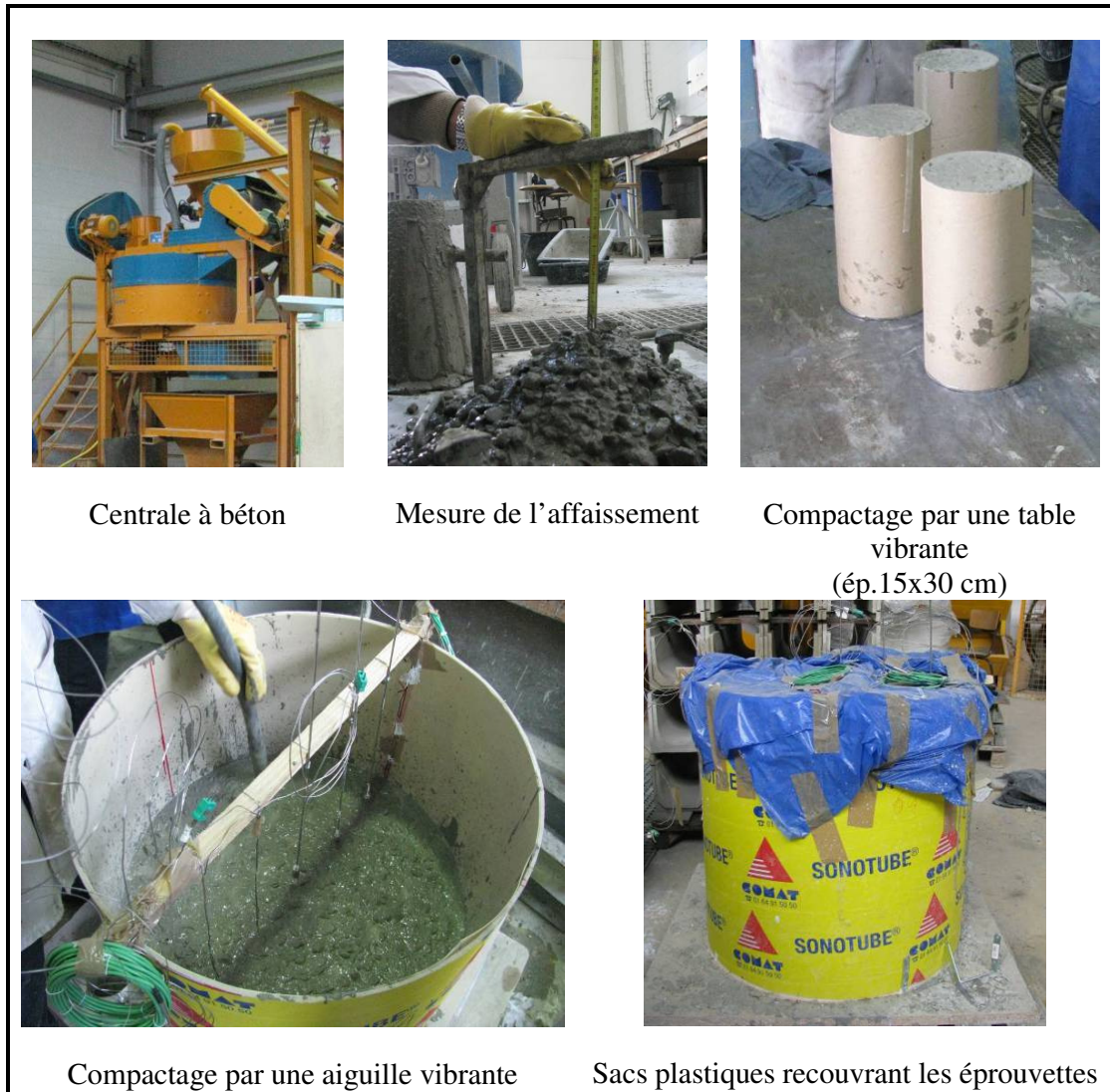
figure II-4 : Confection des éprouvettes de béton
