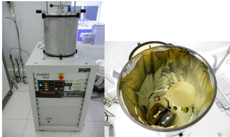
Figure D-17, A gauche, bâti d'évaporation par effet Joule, à droite, vue intérieur du bâti d'évaporation.
