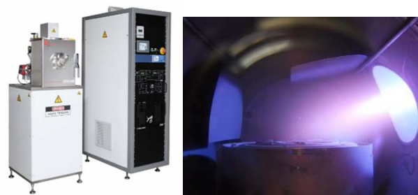
Figure D-18, à gauche, vue d'ensemble du bâti de pulvérisation cathodique, à droite, dépôt de métal à partir du bombardement d'une cible métallique par plasma.
