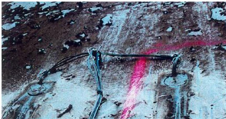
Figure 29. Photo des carottes instrumentées mises en place.
