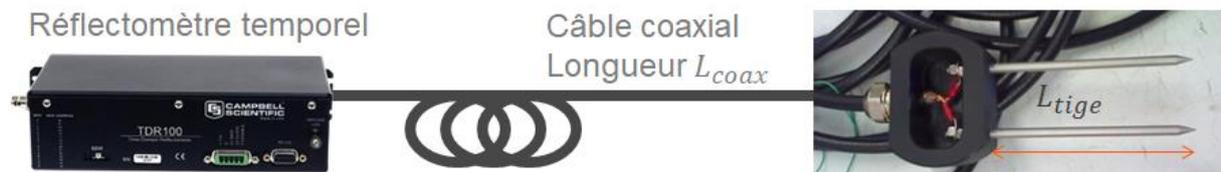
Figure 43. Exemple de chaîne de mesure TDR.
