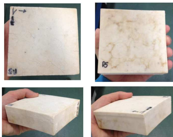
Figure 6 : Photos de l'échantillon sans prétraitement thermique, en haut à gauche la face 1 (celle que l'on exposait aux sels), en haut à droite la face opposée à la face 1, les deux photos du bas montrent les côtés de l'échantillon. La face 2 (la face qui était vers le bas lors de la position à la verticale de l'échantillon est visible en bas à droite). (Photos BILUSTYAK)
