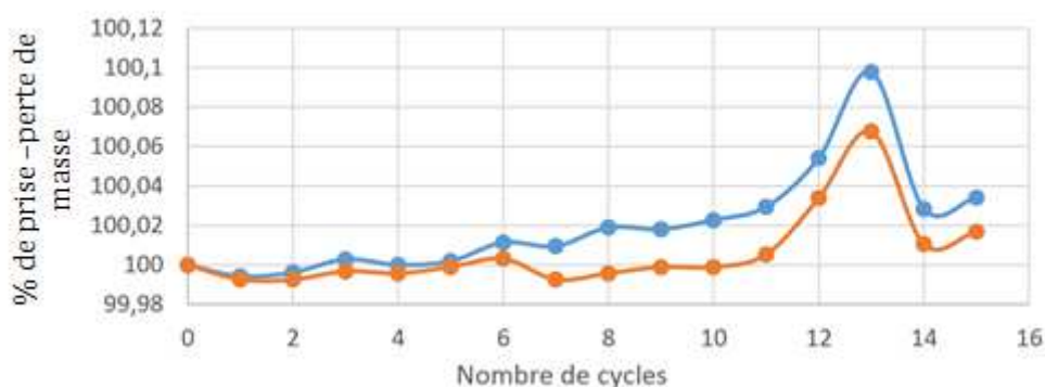
Figure 7 : Graphique montrant l'évolution de la masse des échantillons en fonction du nombre de cycle lors du protocole 3 : Avec prétraitement thermique (bleu) et sans prétraitement thermique (orange).
