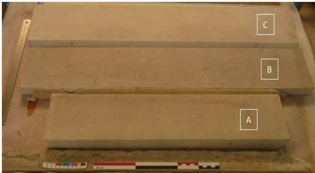
Figure II-1: Les échantillons de plinthes de piédestaux de statues vieilles naturellement dans le parc de Château de Versailles A, B et C
