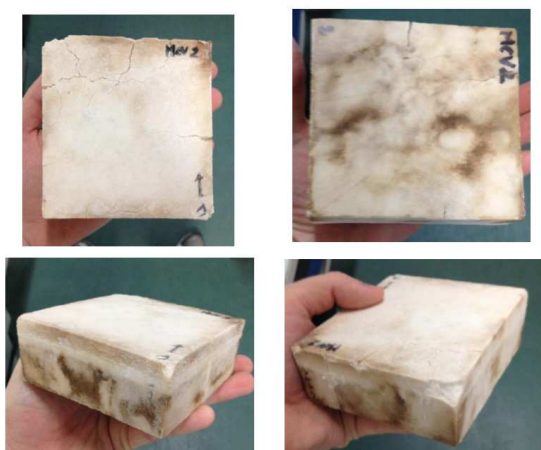
Figure 5 : Photos de l'échantillon avec prétraitement thermique, en haut à gauche la face 1 (celle que l'on exposait aux sels), en haut à droite la face opposée à la face 1, les deux photos du bas montrent les côtés de l'échantillon (S. BILUSTYAK)
