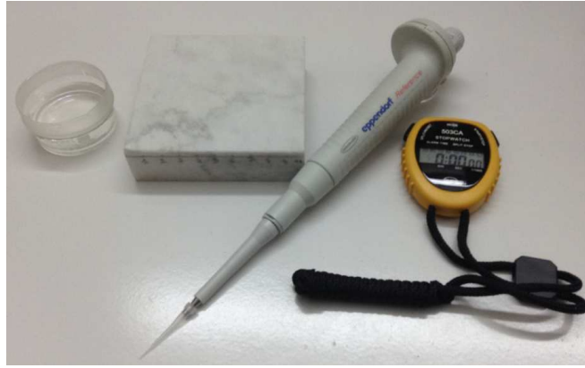
Figure II-10 : Matériel nécessaire pour la mesure de capillarité par la méthode de la goutte d'eau
