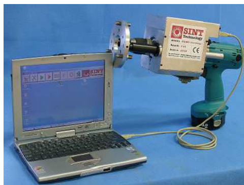
Figure II-21 : Dispositif expérimental pour le test de la résistance au percement.
