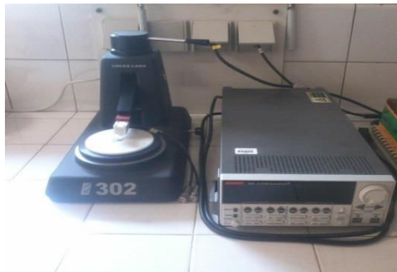
Figure II. 13. Station de mesure de la résistivité électrique par la méthode des quatre pointes
