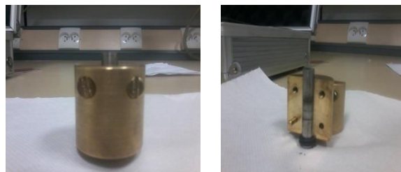
Figure V. 3. Moule utilisé pour la réalisation des tores
