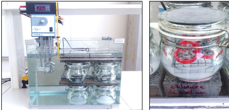
Figure III.14 : Photographies du bain thermostaté et d'un bocal étanche contenant la solution saline et des échantillons dans les coupelles rouges.
