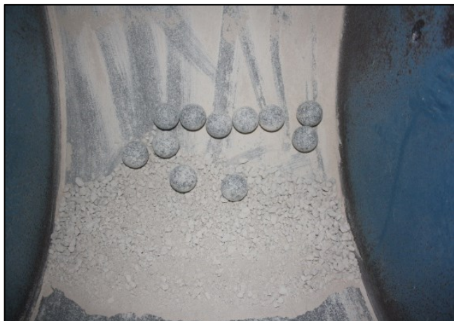
Figure III.3 : Photo du tambour avec des morceaux de pâte de ciment et les boulets métalliques.
