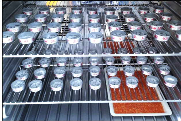
Figure III.30 : Prétraitement des fragments de pâtes (72 coupelles) dans une étuve à 40 \pm 1 °C et HR 10 \pm 2 % pour l'essai de sorption (le bac de gel de silice a été utilisé au début du prétraitement afin d'absorber l'eau et d'atteindre ainsi rapidement l'HR voulue).
