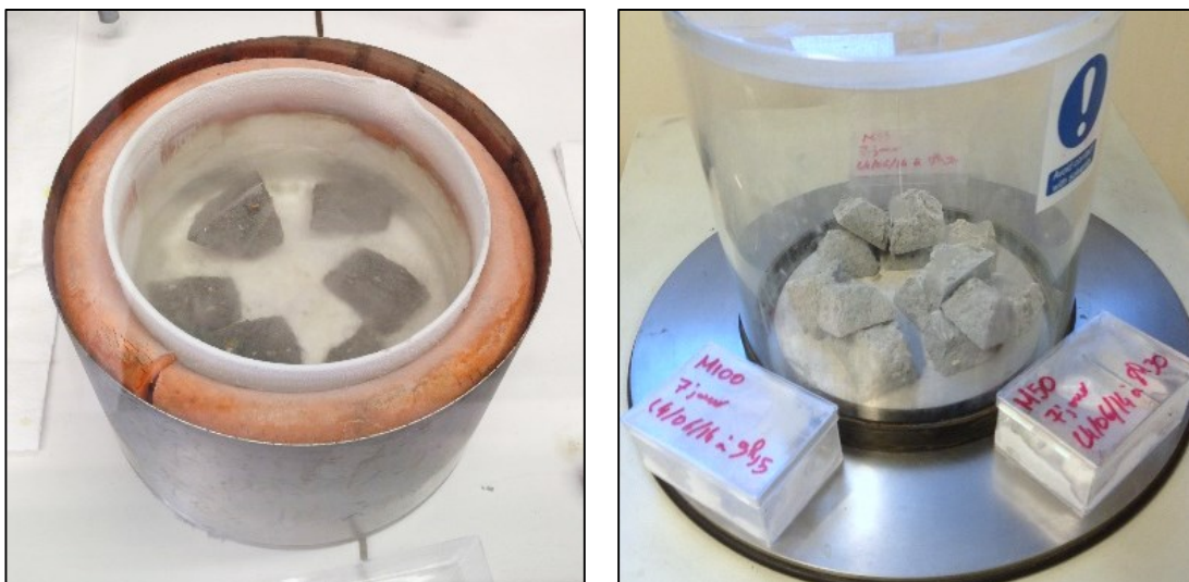
Figure III.18 : Photographies de la trempe dans l'azote liquide d'échantillons de mortier et de la phase de mise sous vide des échantillons dans le lyophilisateur.
