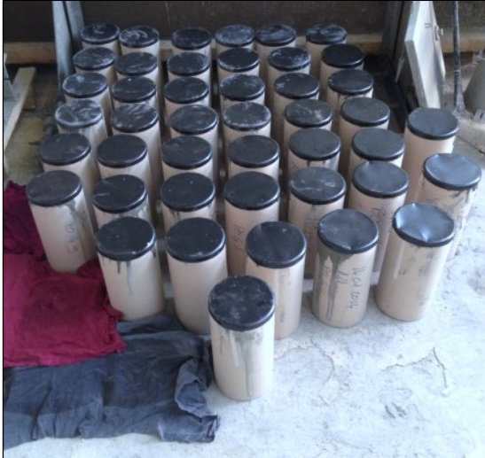
Figure III.1 : Les 44 moules cylindriques contenant la pâte de ciment et les moules prismatiques sous les chiffons humides.
