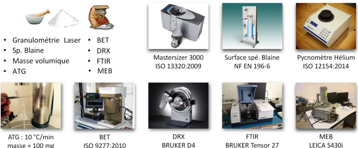
Figure III.33 : Photographies et détails de certains essais réalisés sur FPO et le ciment CEM I 52,5 N.
