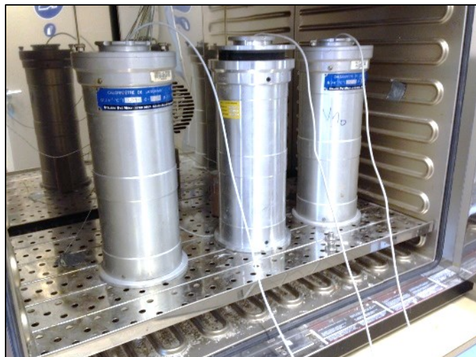
Figure III.19 : Photographie de trois calorimètres utilisés pour la calorimétrie semi-adiabatique dans une étuve.
