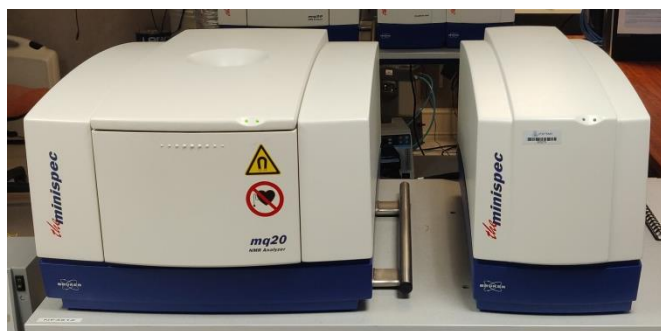
Figure 3-6 : Bruker minispec MQ20 du laboratoire Navier.
