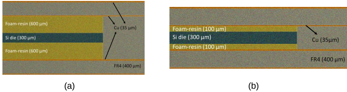
Figure 3.39 Modèle numérique 2D ; (a) utilisant des mousses métalliques d'une épaisseur de 600 \mu\text{m} , (b) utilisant des mousses métalliques d'une épaisseur de 100 \mu\text{m} .
