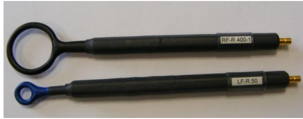
Figure 15 : les sondes de mesure en champ proche
