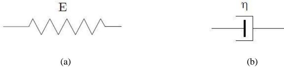
Figure I-16: Éléments de base pour les modèles rhéologiques, a-Ressort, b- Amortisseur linéaire.
