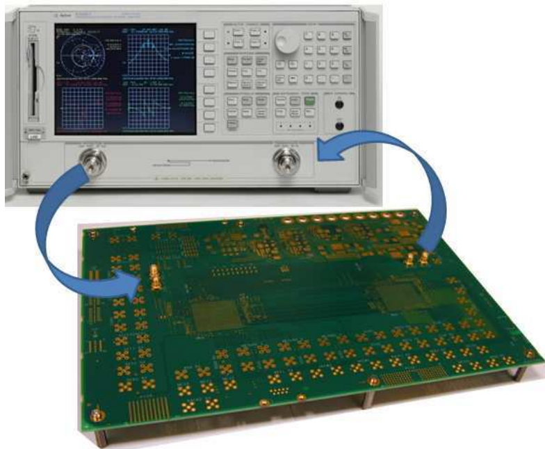
figure 151 : Mesure sur le véhicule de test à l'aide du VNA
