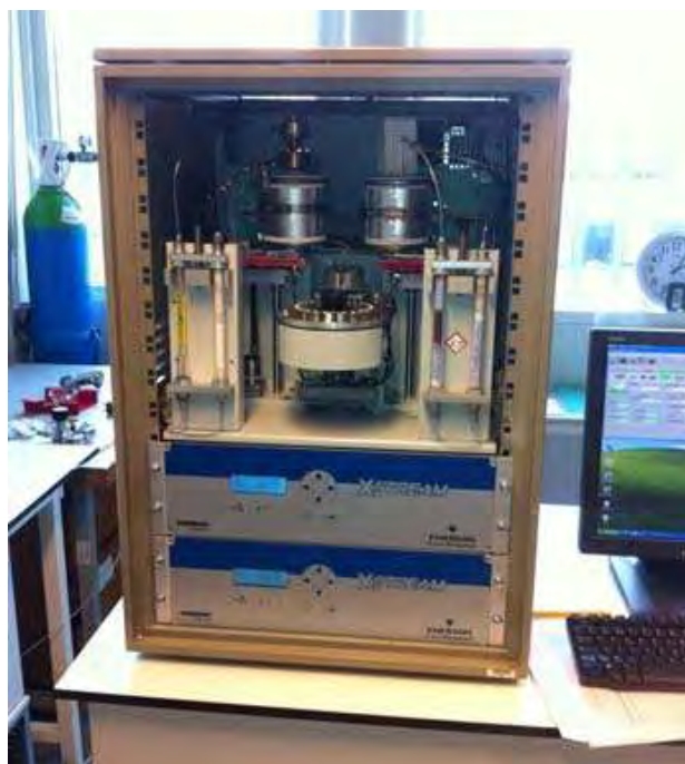
Figure 9 : Appareil de pyrolyse Rock-Eval. (Google.com visité le 4 novembre 2019)
