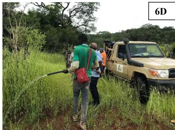
Photos 6A, 6B, 6C et 6D : aperçus de l'échantillonnage des ouvrages hydrauliques, échantillonnage eaux de surface (6A), échantillonnage forage (6B), purgeage forage (6C) et purgeage piézomètre (6D) (Crédit photo : Diouf, 2018)
