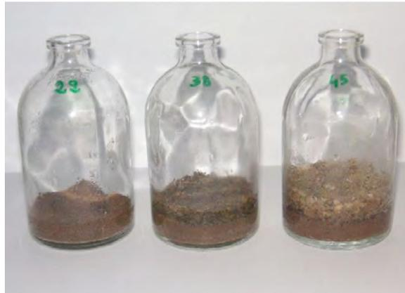
**Photo 1** : Microcosmes de la série 1. De gauche à droite : sol témoin, sol sous paillis d'arachide et sol sous paillis de maïs.
