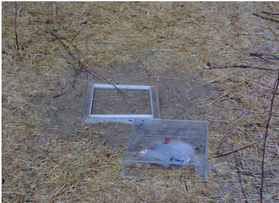
Planche 2 : Base fixe d'une chambre statique
