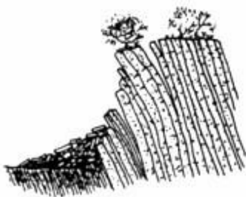
Figure 4: Glissement rocheux de type creep-fauchage (d'après Goodman, 2000)
